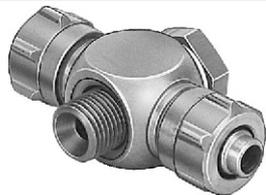
Ниппельные штуцеры для применений в условиях рабочей температуры 60 °С и давления до 10 бар. Шланги с внешним  $\varnothing$  3, 4, 6 и 8 мм и присоединительной резьбой М5, G $\frac{1}{8}$ , G $\frac{1}{4}$ , G $\frac{3}{8}$ , G $\frac{1}{2}$ .
